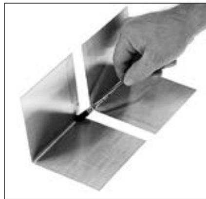
Auftragen des Flussmittels
