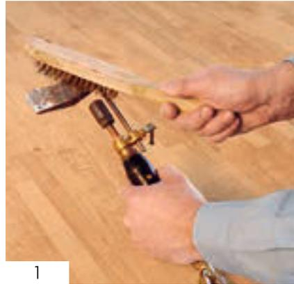
**1.** Reinigen Sie den Kolben mit einer Drahtbürste. Entfernen Sie oxidiertes Material, weil dieses andernfalls die Wärmeleitfähigkeit extrem verschlechtert.
